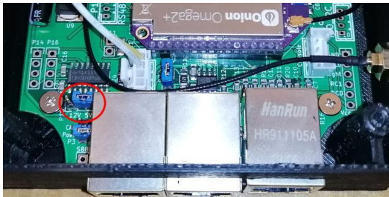
s88 Jumper für Spannungsauswahl 12V / 5V
